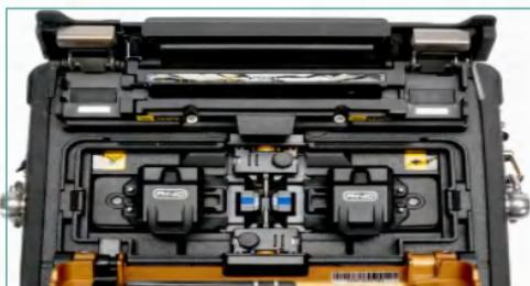
注意：请勿沿着 V 型槽滑动光纤。光纤切面应超出 V 槽位置，但不应超过电极棒尖端位置。（如图）
