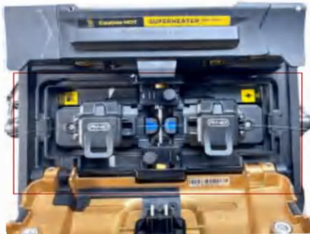
注意：请勿沿着 V 型槽滑动光纤。光纤切面应超出 V 槽位置，但不应超过电极棒尖端位置。（如图）
